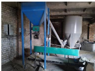
Весовой бункерный дозатор с ленточным транспортером и мешкосшивателем
