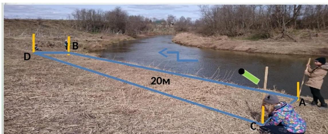
Рисунок 2 - Определение скорости течения реки
