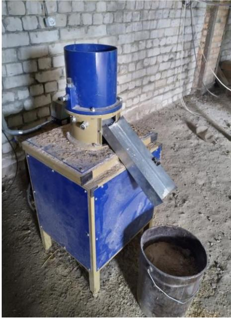
Рисунок 8 - Гранулятор ГМ-150
