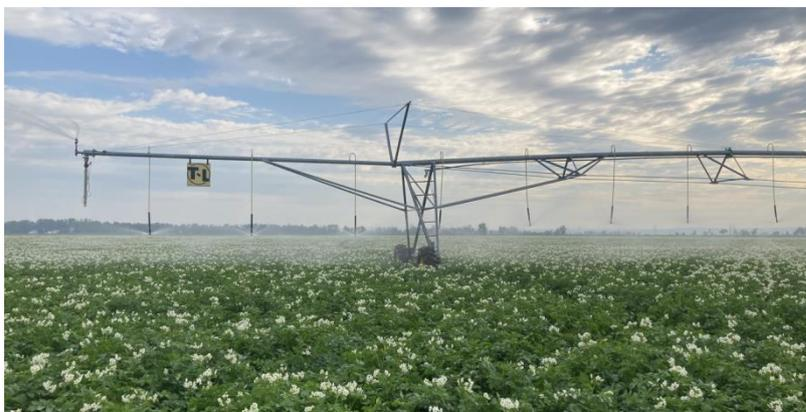
**Рисунок 1 – Фрагмент общего вида в движении ШКДМ фирмы T-L Irrigation company с опорной тележкой и концевой пушкой**
